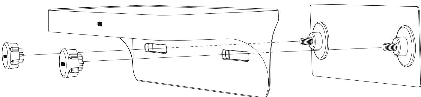
**7** Twist clockwise to tighten / Faites tourner le bouton dans le sens des aiguilles d'une montre pour resserrer / Gire en sentido del horario para apretar / Im Uhrzeigersinn festdrehen / Gire no sentido horário para apertar / Ruotare in senso orario per stringere
